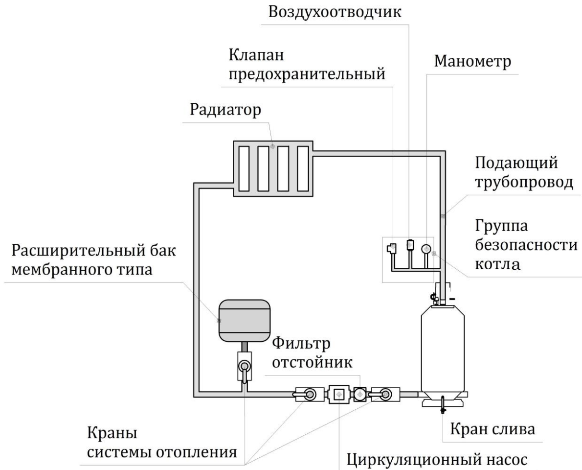
Рисунок 14 – Схема закрытой системы отопления с принудительной циркуляцией
