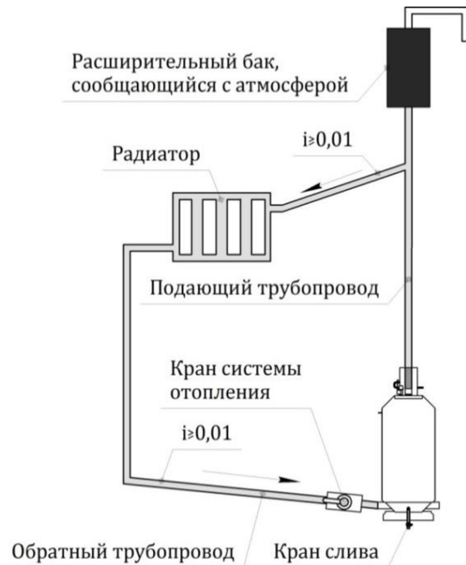
Рисунок 8 – Схема открытой системы отопления с естественной циркуляцией
